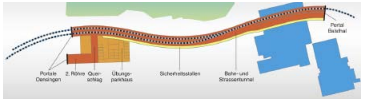
Un tunnel routier-ferroviaire combiné est construit à Balsthal
