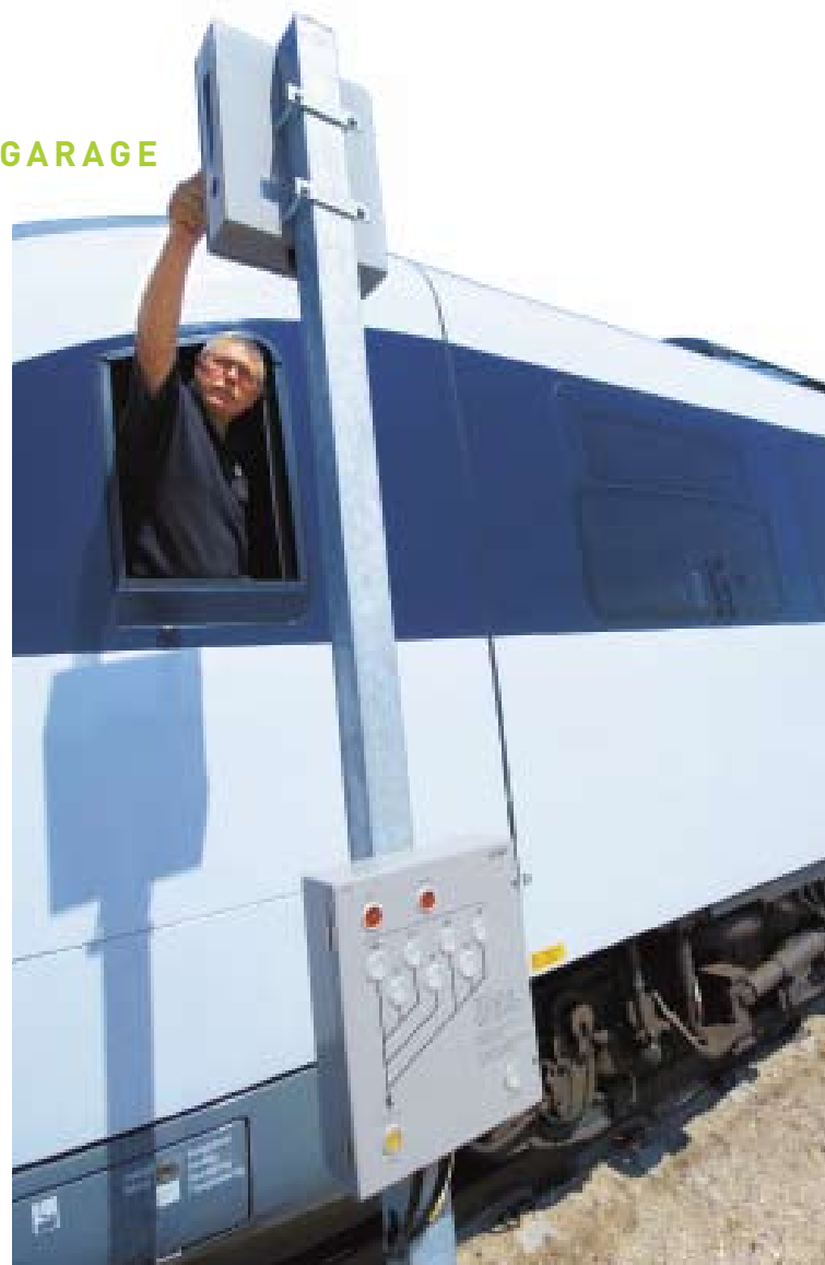
Les conducteurs règlent et assurent maintenant eux-mêmes les itinéraires dans les dépôts.
