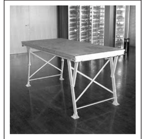
Bühnen-Mehrweckele- ment für den Inneneinsatz (ohne Publikumszulassung) Podestgröße: 200 x 100 cm einstellbare Höhen: 16,6 cm, 33,3 cm, 50 cm, 66,8 cm, 80 cm oder 100 cm. Rahmenkonstruktion aus Aluminiumprofilen, Auflage- flüsse aus Kunststoff Belastung pro Element: max. 200 kg Multi-Purpose Staging for indoors only (without per- mission for public) Dimensions: 200 x 100 cm Settings of Height: 16.6 cm, 33.3 cm, 50 cm, 66.8 cm, 80 cm or 100 cm. Framework of deck profiled aluminium, for indoor instal- lations. Trellis feet protected by plastic Capacity per platform: 200 kg max
