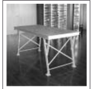
Bühnen-Mehrzweckelement für den Inneneinsatz (ohne Publikumszulassung) Podestgröße: 200 x 100 cm einstellbare Höhen: 16,6 cm, 33,3 cm, 50 cm, 66,8 cm, 80 cm oder 100 cm. Rahmenkonstruktion aus Aluminiumprofilen, Auflage- flüsse aus Kunststoff Belastung pro Element: max. 200 kg Multi-Purpose Staging for indoors only (without per- mission for public) Dimensions: 200 x 100 cm Settings of Height: 16.6 cm, 33.3 cm, 50 cm, 66.8 cm, 80 cm or 100 cm. Framework of deck profiled aluminium, for indoor instal- lations. Trellis feet protected by plastic Capacity per platform: 200 kg max
